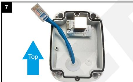
Positionieren Sie die Anschlussbox mit der Dichtung unten und der Anschlussplatine oben.
