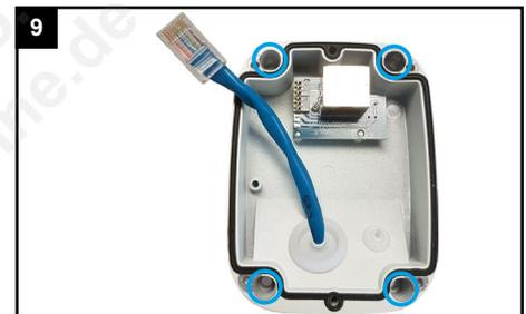
...und befestigen Sie die Anschlussbox mit den vier Gewindeschrauben aus dem Lieferumfang.
