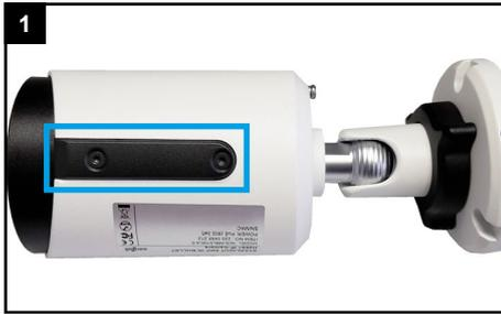
Auf der Unterseite der Kamera befindet sich eine schwarze Abdeckung mit zwei Schrauben.
