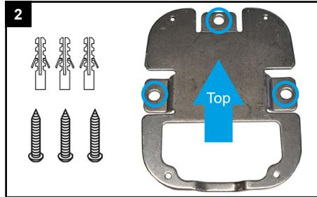
Befestigen Sie die Montageplatte mit den mitgelieferten Schrauben und Dübeln. Die Öffnung für die rückseitige Kabelzufuhr sollte dabei wenn möglich unten sein.
