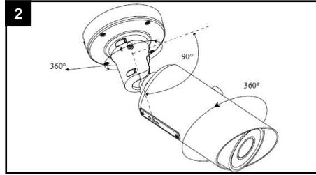
Sie können die Kamera um 90 Grad schwenken / neigen und um 360 Grad drehen.
