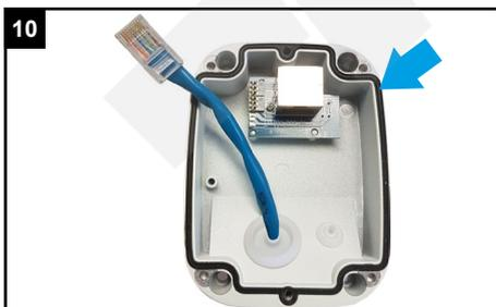
**Wichtig:** Achten Sie darauf, dass die schwarze Dichtung bündig aufliegt. Es darf sich kein Schmutz oder Staub auf der Dichtung befinden. Dies würde die Dichtheit beeinflussen.
